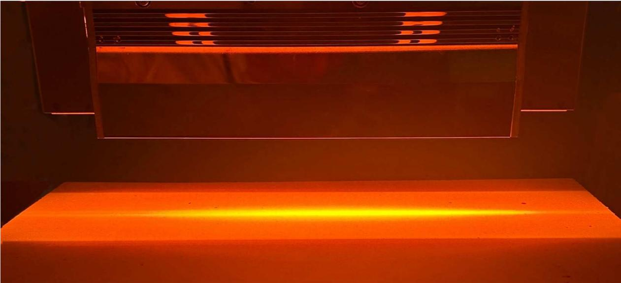
Bata tahan api disinari dengan HLH-65W/f75/L280 dari jarak pengenal 75mm.
